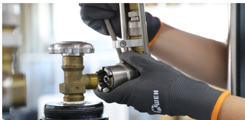
Befüllen & Evakuieren von Gasflaschen
