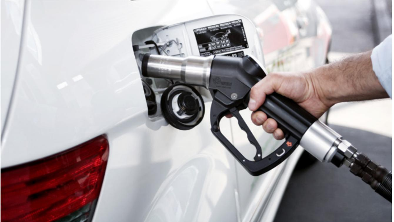
Ravitaillement d'une automobile avec le type TK17 CNG
