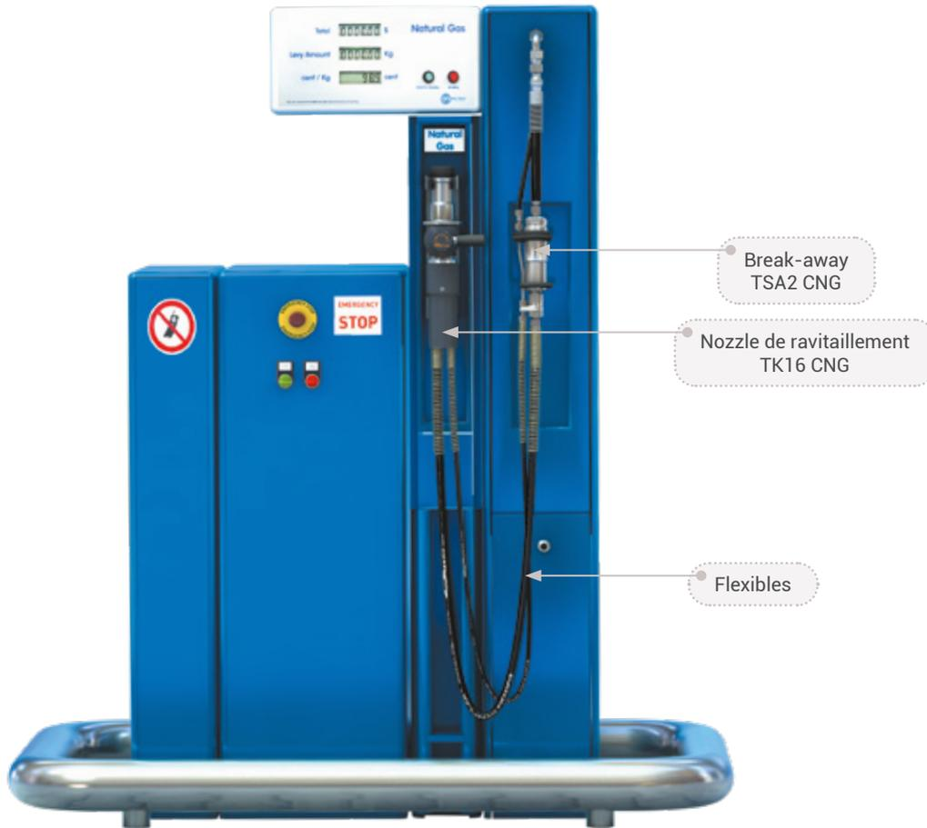
Nous vous offrons des ensembles de ravitaillement entièrement assemblé et testé sous pression. Le set contient le nozzle de ravitaillement, les flexibles et le break-away. Les ensembles sont disponibles avec des flexibles aux différentes tailles standard. Ils peuvent être équipés avec le break-away type TSA1 CNG pour le montage directement au distributeur ou avec le break-away en ligne type TSA2 CNG pour le montage entre les flexibles.
