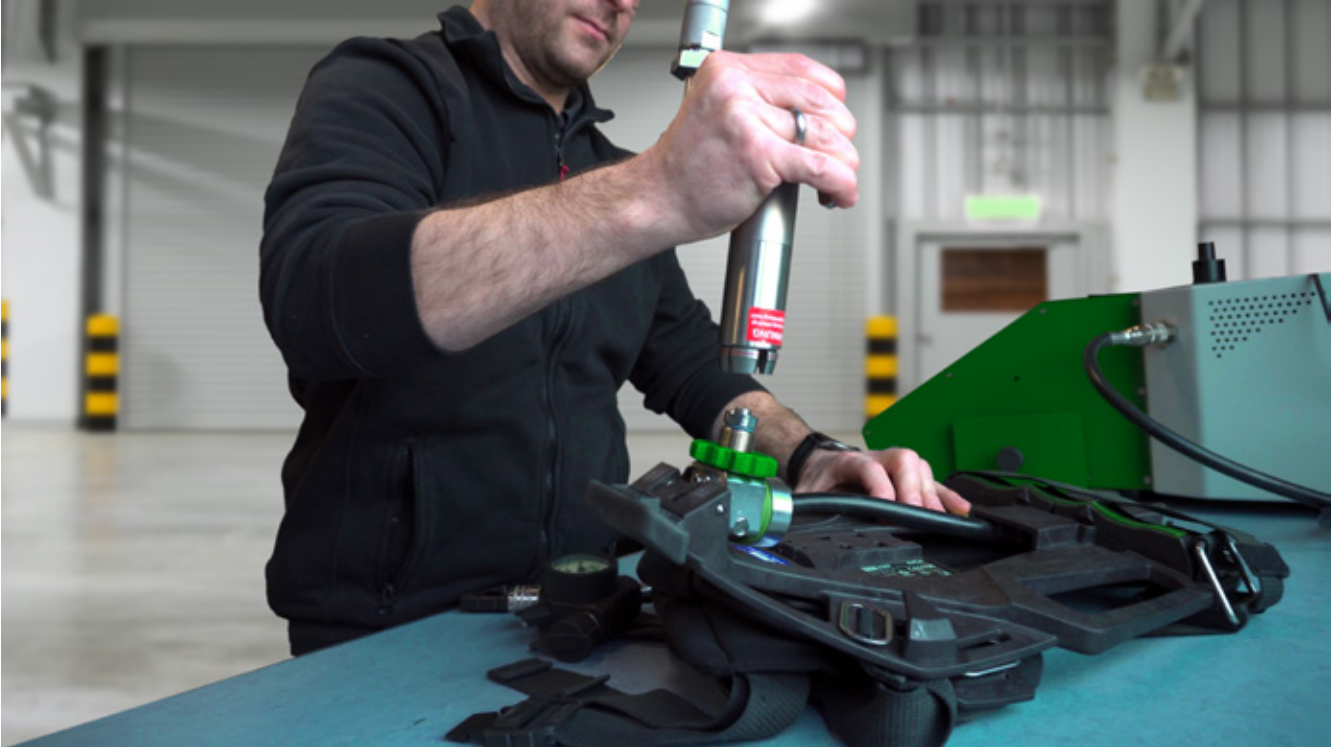
Prüfen von Atemschutzgeräten mit WEH® Adapter TW156.
