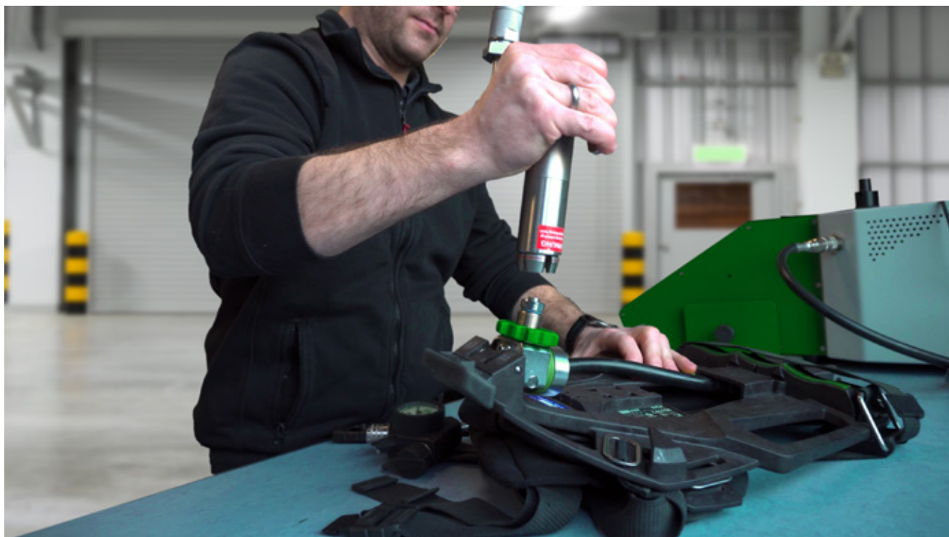
Test d'appareils de protection respiratoire avec WEH® connecteur TW156.
